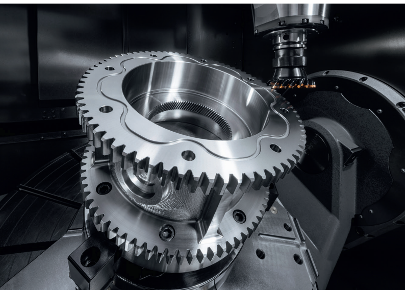
1 Hermle-Technologie-Show in Stuttgart: anlässlich der AMB wird auf einem 5-Achs-Fräsdrehzentrum C 42 U MT (Mill/Turn) dieses Technologiebauteil mit 13 Technologien vorgeführt © Hermle
